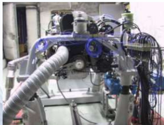
Bancs moteurs thermiques
