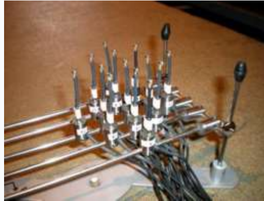
Antenne de capteurs pression / vitesse acoustique
