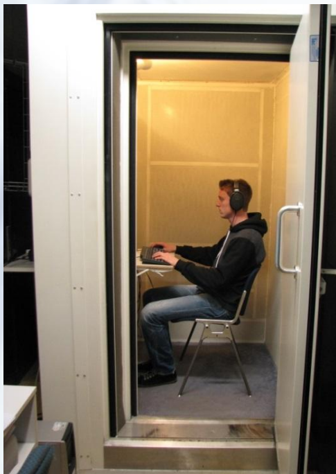
Cabine audiométrique pour test d'écoute au casque
