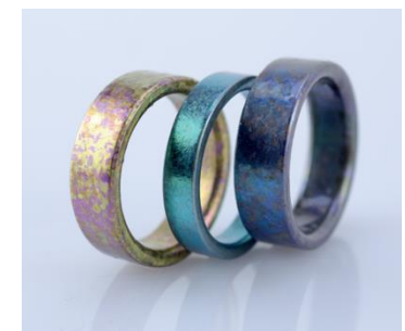
✓ Anodisation et texturation de surface du titane pour obtenir le rendu visuel souhaité
